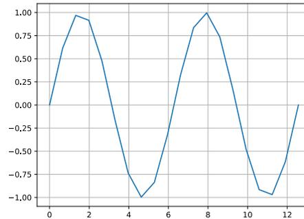
Figure 11. – La fonction sinus sur  $[0, 4\pi]$ , avec trop peu de points d'échantillonnage.
