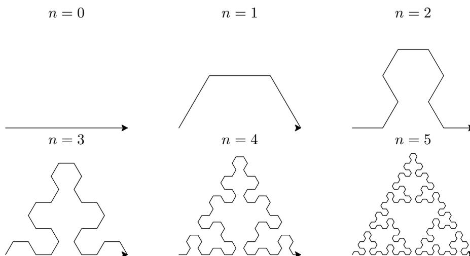
Encore une fois pour  $n = 0$  il s'agit d'une ligne droite, et pour  $n = 1$  on appellera cela une *tuile*. À chaque étape, les morceaux de ligne droite sont remplacés par des tuiles. Mais attention ! Il y a deux types de tuiles, celles tournant d'abord vers la gauche (comme le cas  $n = 1$  ici) et celles tournant d'abord vers la droite (le premier et le dernier du cas  $n = 2$ , alors que celle du milieu tourne vers la gauche).
